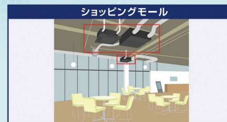
天井カセット4方向室内機 & 全熱交換器ユニット
